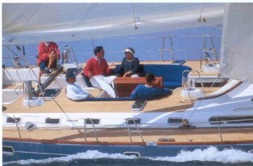
Un plan de pont fonctionnel avec deux cockpits : à l'arrière celui des manœuvres, au centre celui dévolu aux instants de détente.
